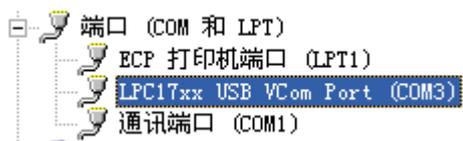
右键选择属性--端口设置，可以设置此虚拟串口的波特率等信息；分别用串口工具打开 COM1 和 COM3，设置如下：
